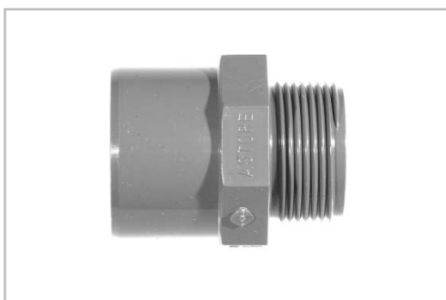
Übergangsnippel, DN 40 einerseits zum Einkleben in DN 40 PVC-U Fittinge andererseits Außengewinde R 1 1/4"
