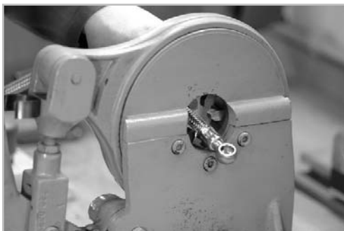
Montagehülsen, Werkstoff: Edelstahl 1.4301 (V2A)
