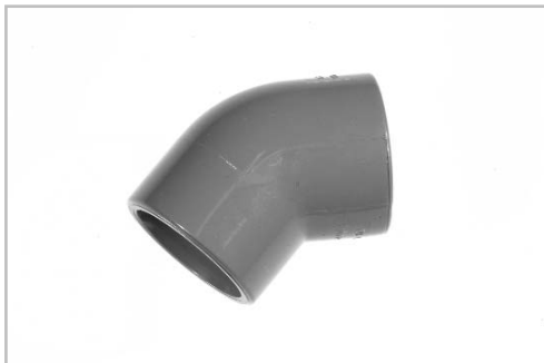
Klebefitting Winkel 45°, DN 40 beiders. zum Aufkleben auf PVC-Rohr DN 40
